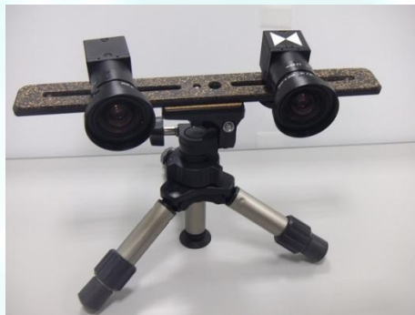
<参考例:Flea2を2台組み合わせたステレオカメラ構成>
