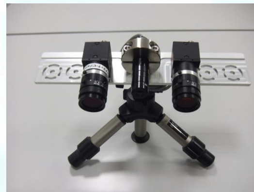
<参考例:Flea2を2台組み合わせたステレオカメラ構成>
